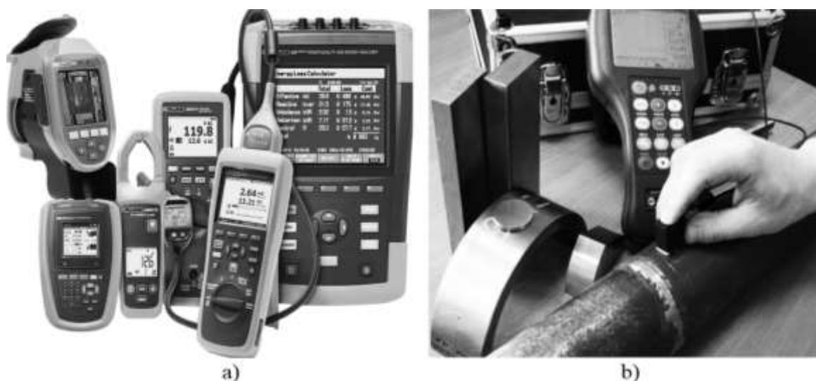
5.15-rasm. Mashinasozlik ishlab chiqarishlarida robotlar yordamida mexanik ishlov berilgan detallar, buyomlar yoki maxsulotlarning sifatini nazorat qilyvchi-tekshiruvchi priborlari: a–nazorat-o'lchov priborlari; b–nazorat-o'lchov jarayonlari.
