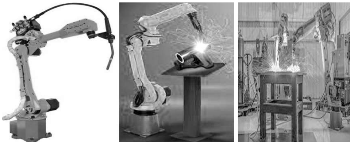
5.23-rasm. Sanoat robotlari-manipulyatorining umumiy ko'rinishlari va ish faoliyatlari.
