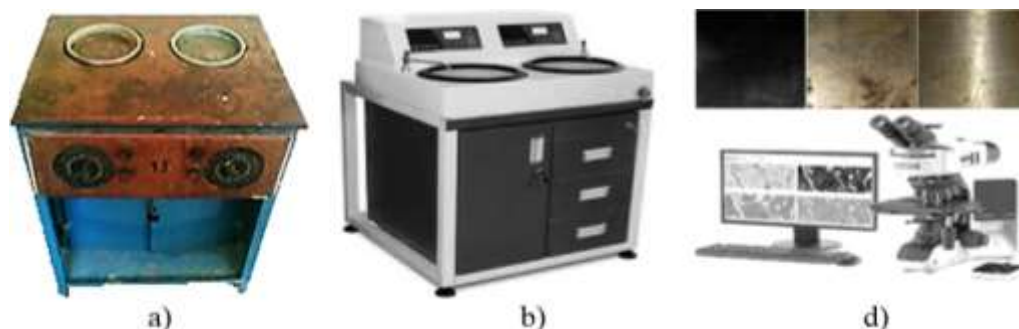
3.7-rasm. Metall namunalarini silliqlovchi dastgohlar: a -avvalgi eski holati; b -yangi zamonaviy holati; d -tepa qismi namunalarni silliqlash ketma-ketligi va pastki qismi ichki struktura tuzilishlarini o'rganuvchi mikroskopi.
